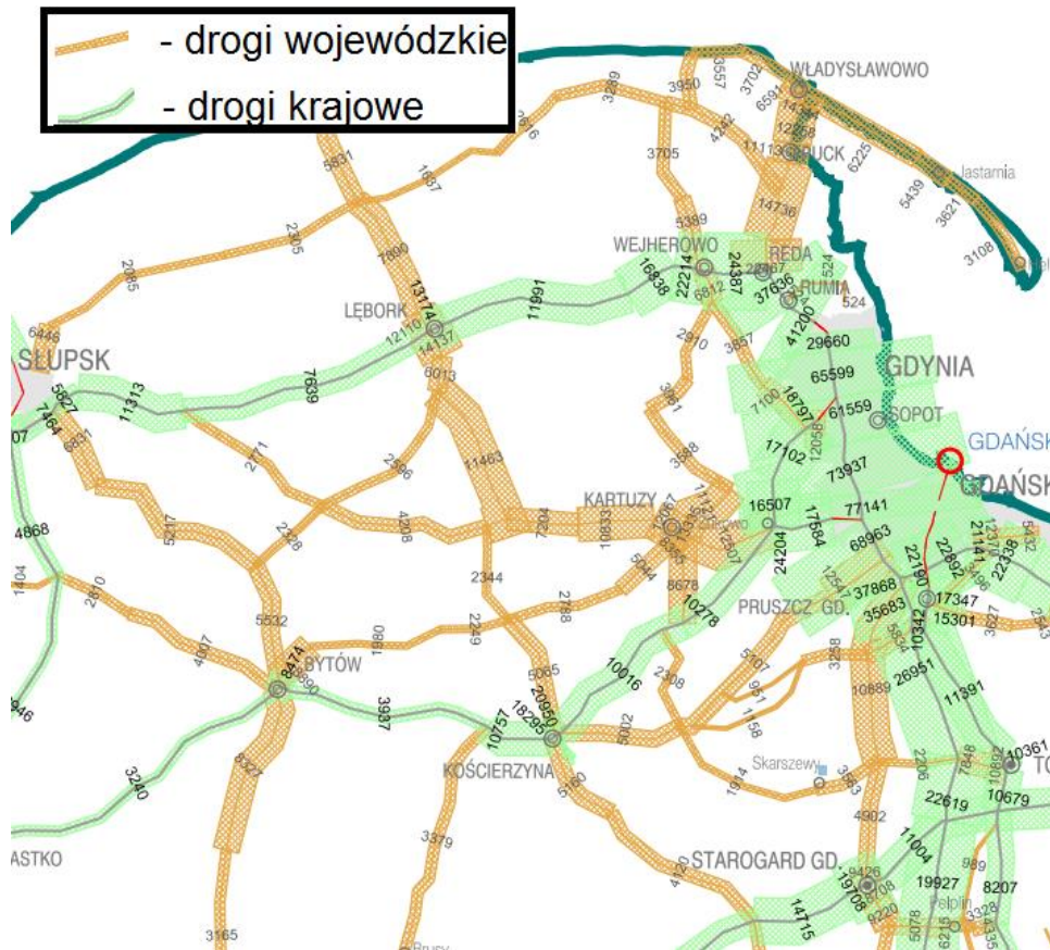
Ryc. 6. Średni dobowy ruch pojazdów na drogach krajowych i wojewódzkich we wschodniej części województwa pomorskiego wg GPR 2015
